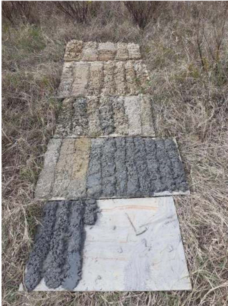
Echantillons de terrain relevés par le foreur (échantillon métrique par séquence de 3m)
